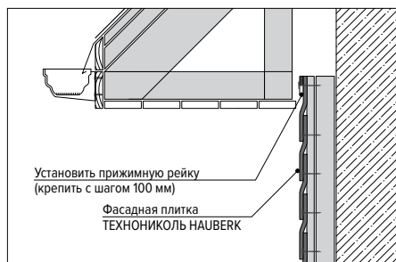
Рис. 9.1. Монтаж верхнего ряда под карнизным свесом. Вариант 1
